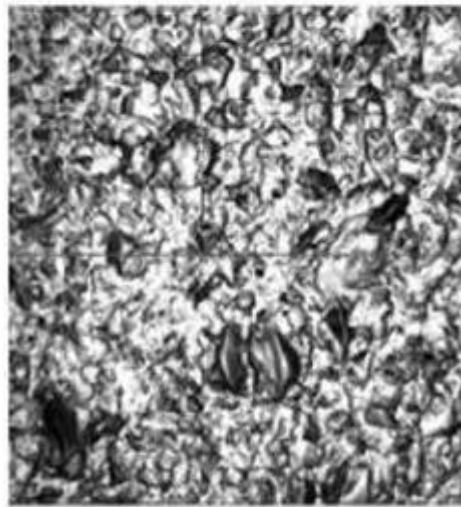
图2 砂浆单晶切片表面形貌(摩尔光伏
