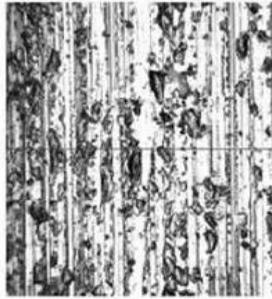
图1 金刚石线单晶切片表面形貌(伏
